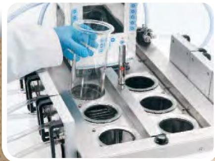
**Grand réservoir** à 6 tubes pour réaliser simultanément un plus grand nombre d'essais pour économiser du temps et de l'argent.
