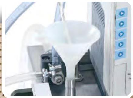
Système de remplissage **facile à utiliser** sur le dessus de l'unité et évacuation à l'avant. Des instructions pas à pas sont fournies pour la préparation de l'unité.
