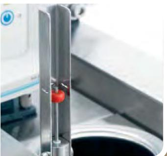
Le niveau de liquide visible pour le maintien des niveaux appropriés.
